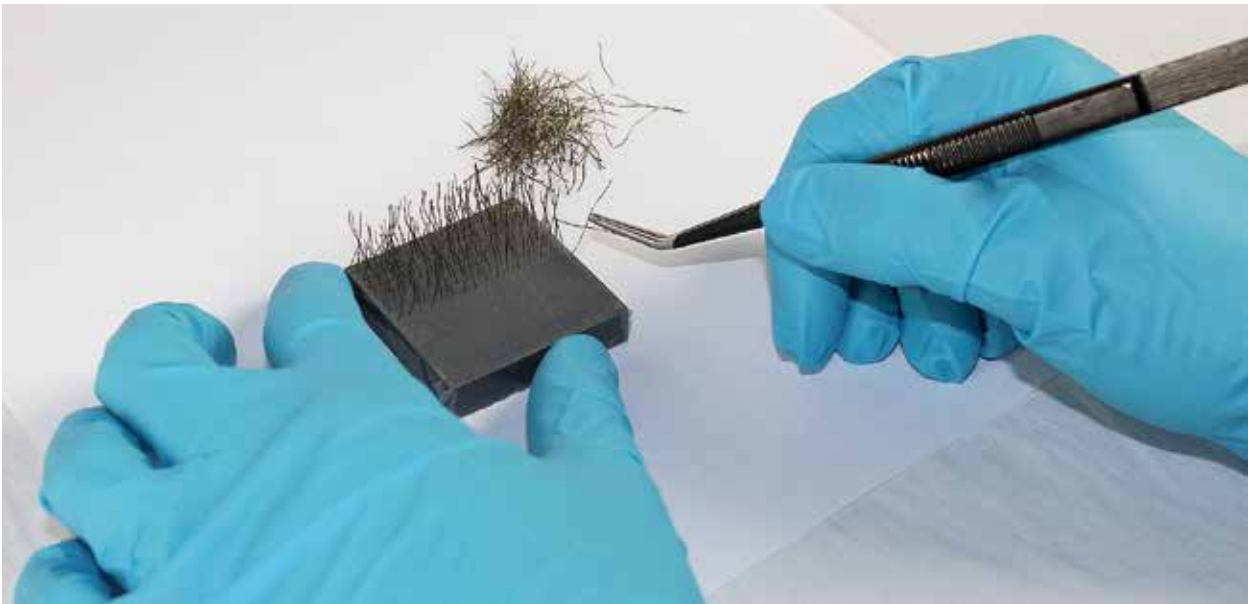
Bild 2: Aufbau einer definierten Stahlfaserverstärkung für die Verklebung von ultrahochfestem Beton.
