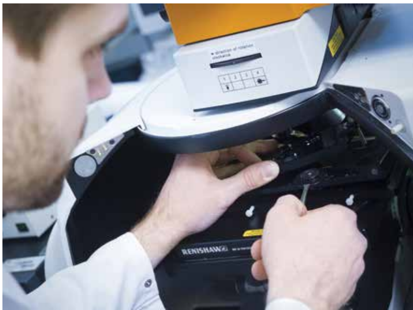
Bild 2: M. Sc. Simon Burkhardt (1. Physikalisches Institut, JLU Gießen) untersucht am in STORE-E etablierten spitzenverstärkten Ramanmikroskop neue Batteriematerialien. (© Hessen schafft Wissen – Jan Michael Hosan)
