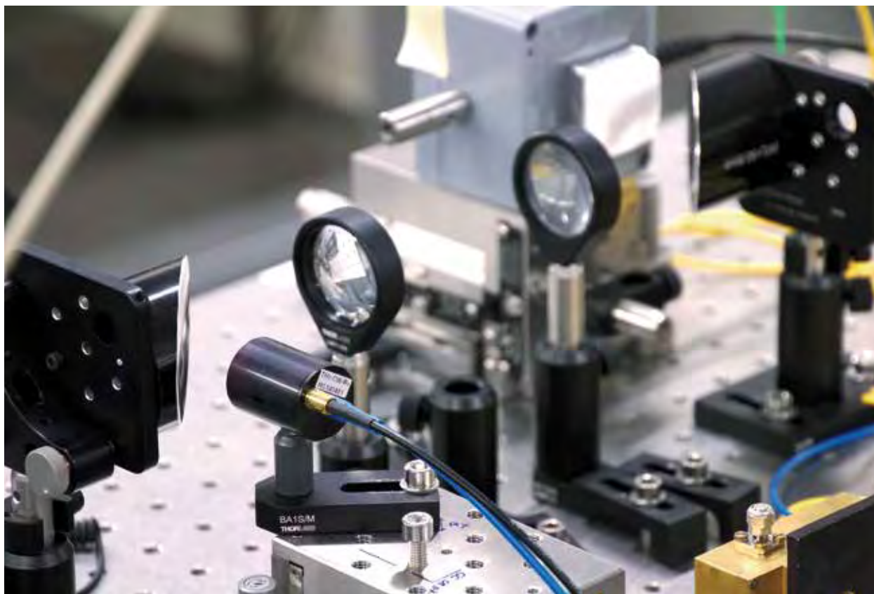
Bild 4: Aus LOEWE-Mitteln beschaffter Dauerstrich-Terahertz-Aufbau zur breit- und schmalbandigen Charakterisierung verschiedenster Materialien und Proben. (© C. Weickmann/TU Darmstadt)
