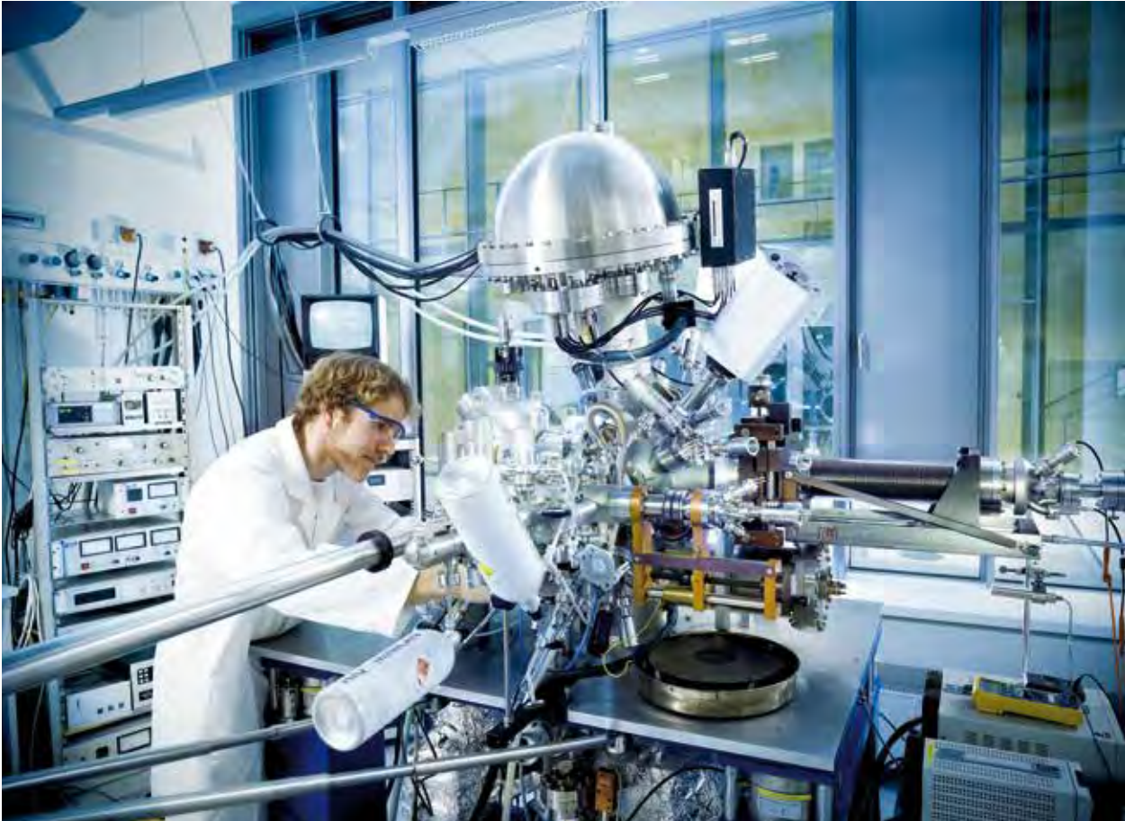
Bild 1: M. Sc. Christian Sack (Physikalisch-Chemisches Institut, JLU Gießen) untersucht die Grenzflächeneigenschaften von Ceroxidbasierten Katalysatormaterialien mit einer Ultrahochvakuumapparatur. (© Hessen schafft Wissen – Jan Michael Hosan)
