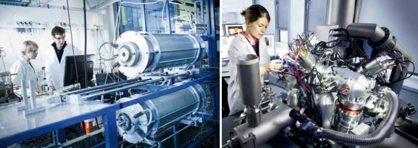
Bild 2: M. Sc. Kathrin Michel und M. Sc. Jonas Neumeier (Physikalisch-Chemisches Institut, JLU) untersuchen mit Hochtemperatur-Leitfähigkeitsmessständen die Eigenschaften von Sauerstoffspeichermaterialien für Abgaskatalysatoren.
