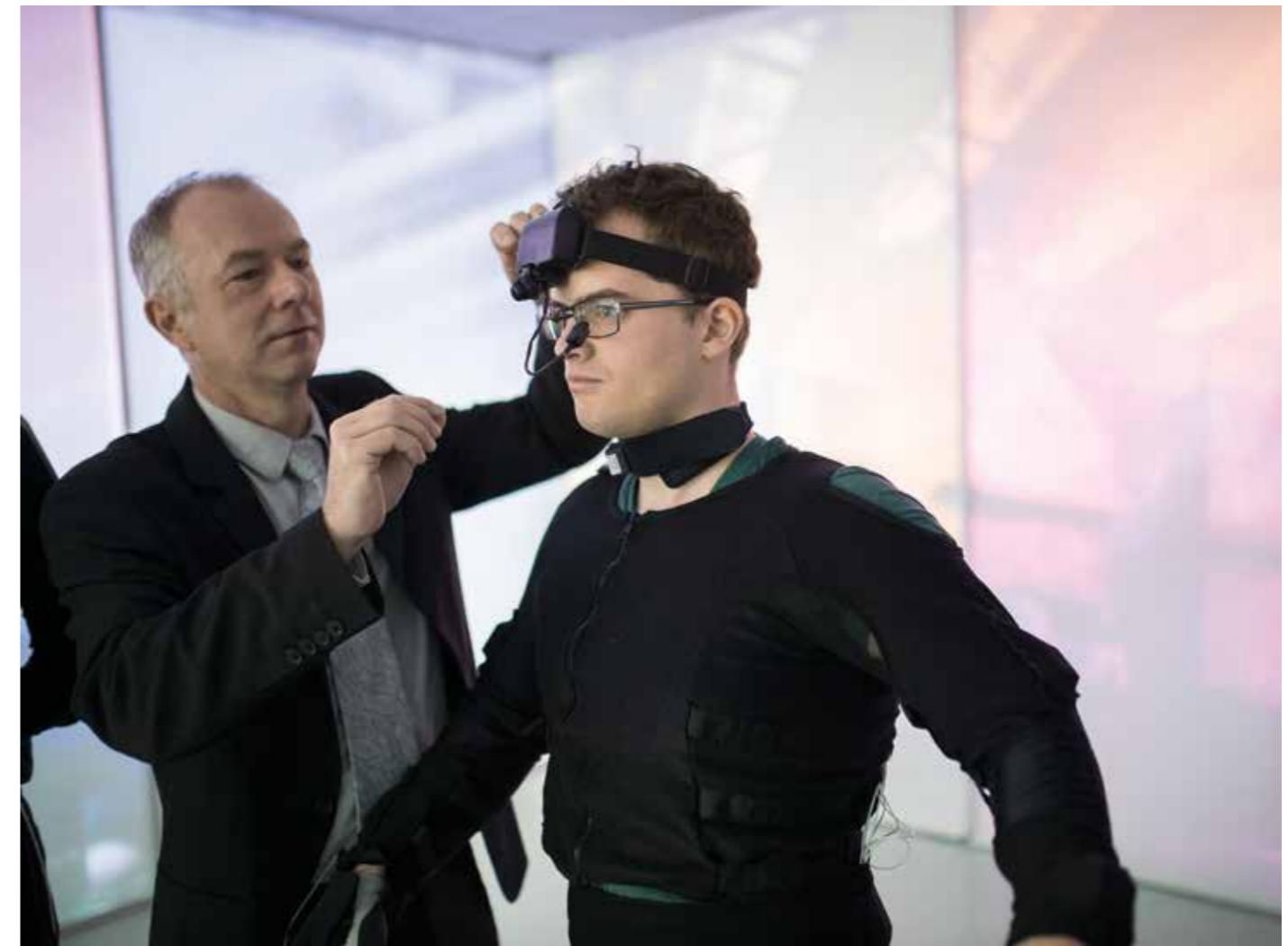
Bild 3: Messaufbau zur Untersuchung von menschlichen Bewegungs- und Verhaltensabläufen (© Uni Kassel/Paavo Blafield)
