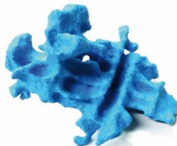
Bild 2: Intrinsischer Fehler in einem Aluminiumgussbauteil – vergrößert und als dreidimensional gedrucktes Element dargestellt.
