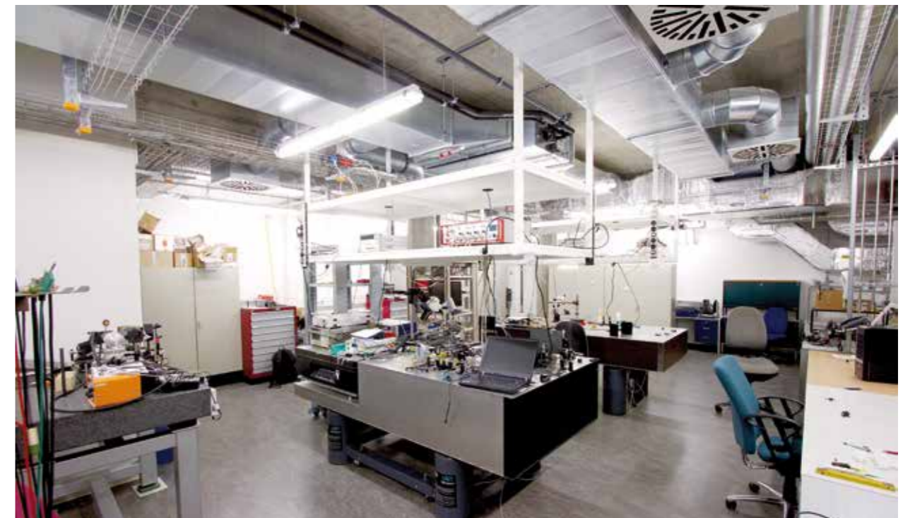
Bild 2: Im Rahmen von STT eingerichtetes Terahertz-Labor mit Aufbauten zur Spektroskopie von ca. 0,5 bis über 4 THz. Diese erlauben die Entwicklung neuer Quellen, Detektoren und Sensorkonzepte. (© TUD, Institut für Mikrowellentechnik und Photonik)
