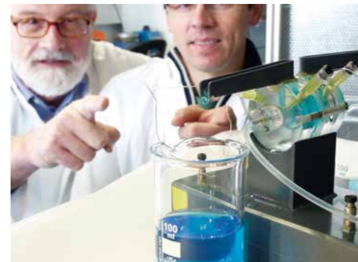
Bild 1: In der sogenannten Ussing-Kammer werden Transportvorgänge an Schleimhäuten untersucht.
