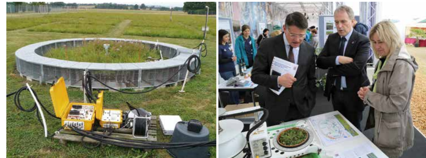
Bild 2: Versuchsfläche mit experimenteller Erhöhung der atmosphärischen CO 2 -Konzentration und Temperatur am extensiv bewirtschaftetem Grünland der Versuchsstation Linden, Institut für Pflanzenökologie, Justus-Liebig-Universität Gießen. Auf der Versuchsfläche befinden sich automatische Messkammern zur Beprobung der Spurengaskonzentrationen (Erfassung der Flüsse von CO 2 und Wasserdampf). Weitere Information zur Umweltbeobachtungs- und Klimafolgenforschungsstation Linden: ( http://www.uni-giessen.de/fbz/fb08/Inst/pflanzenoek/forschungseinrichtungen/UKL ). (© Institut für Pflanzenökologie)
