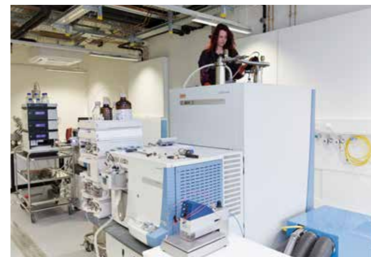
Bild 4: Massenspektrometer ermöglichen die qualitative und quantitative Analyse von kleinen Substanzen, zum Beispiel für Untersuchungen von Stoffwechselvorgängen in Mikroorganismen. Auch die Struktur von Biopolymeren kann entschlüsselt werden. Im Bild: Einfüllen von flüssigem Stickstoff zur Kühlung der supraleitenden Magneten einer LTQ-FT Ultra Anlage, die an ein modernes Orbitrap Velos Pro Gerät gekoppelt ist. (© Rolf K. Wegst, mit freundlicher Genehmigung)
