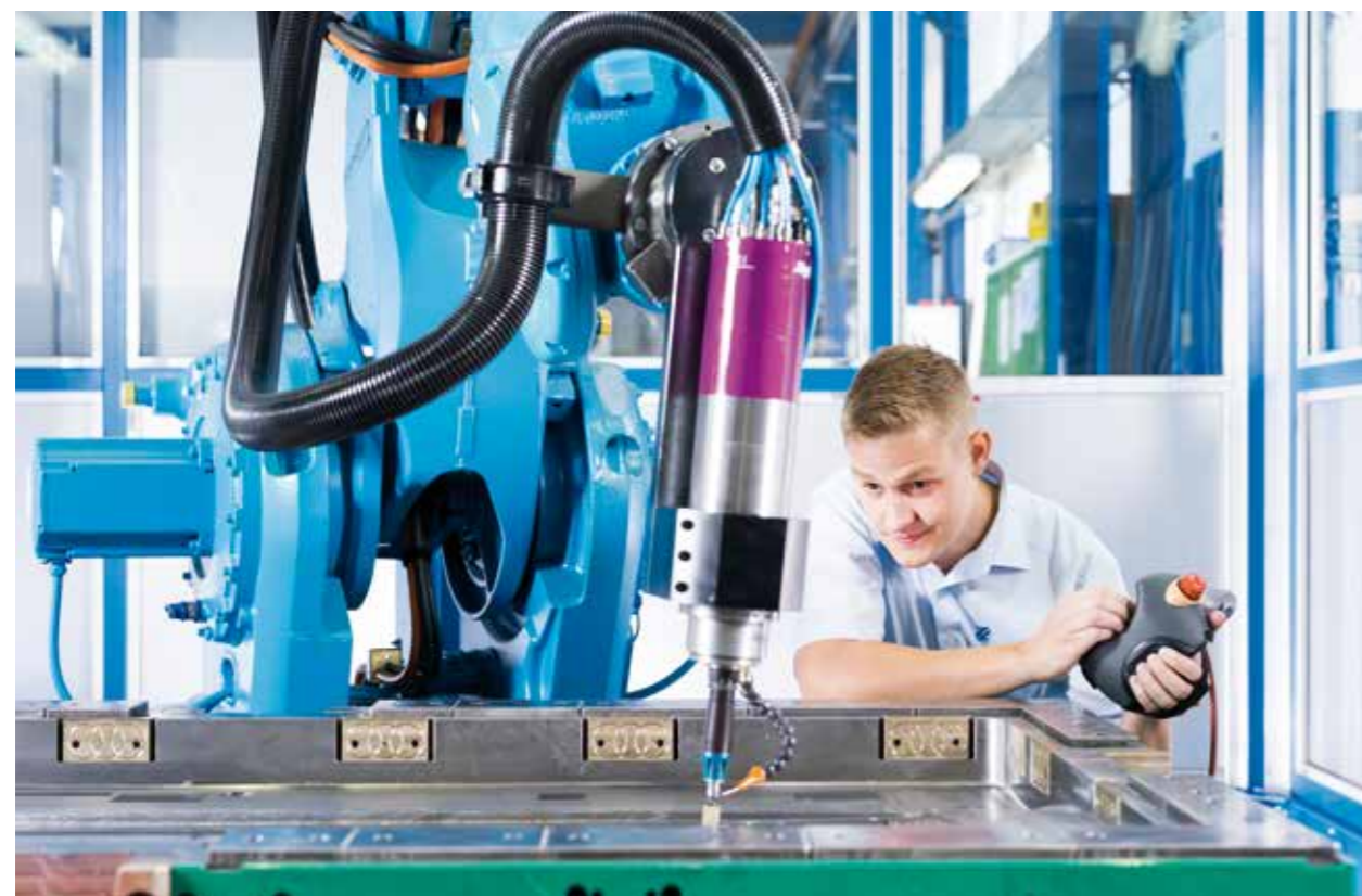
RoWe – Roboterzelle zur Feinbearbeitung von großen Werkzeugen; © HA Hessen Agentur GmbH – Jan Michael Hosan
