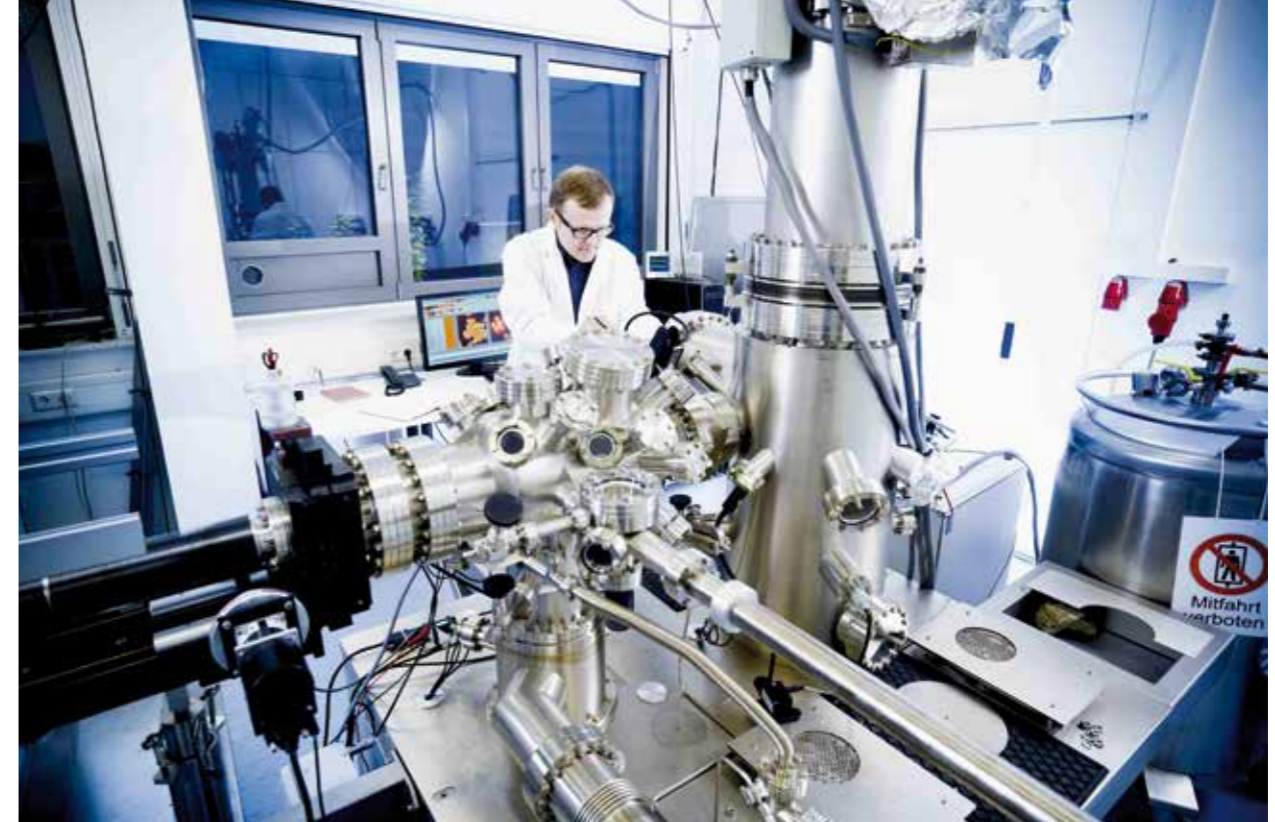
Bild 1: Dr. Daniel Ebeling (Institut für Angewandte Physik, JLU Gießen) misst mit einem Rasterkraftmikroskop die Reibung auf Oberflächen mit atomarer Auflösung.
