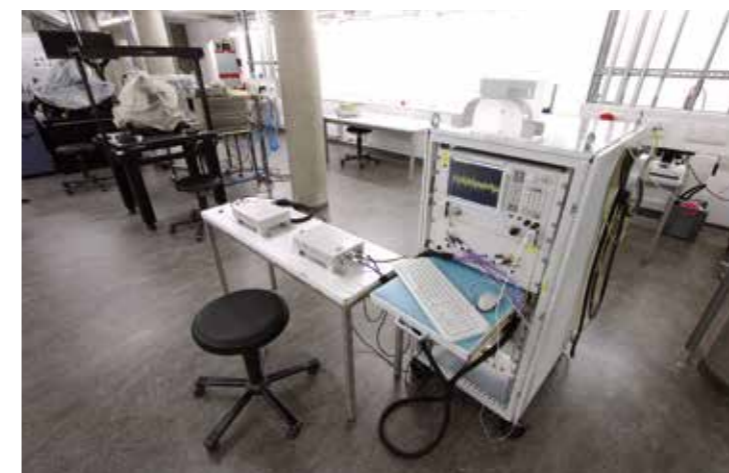
Bild 2: Im Rahmen von STT eingerichtetes Terahertz-Labor mit Aufbauten zur Spektroskopie von ca. 0,5 bis über 4 THz. Diese erlauben die Entwicklung neuer Quellen, Detektoren und Sensorkonzepte. (© TUD, Institut für Mikrowellentechnik und Photonik)
