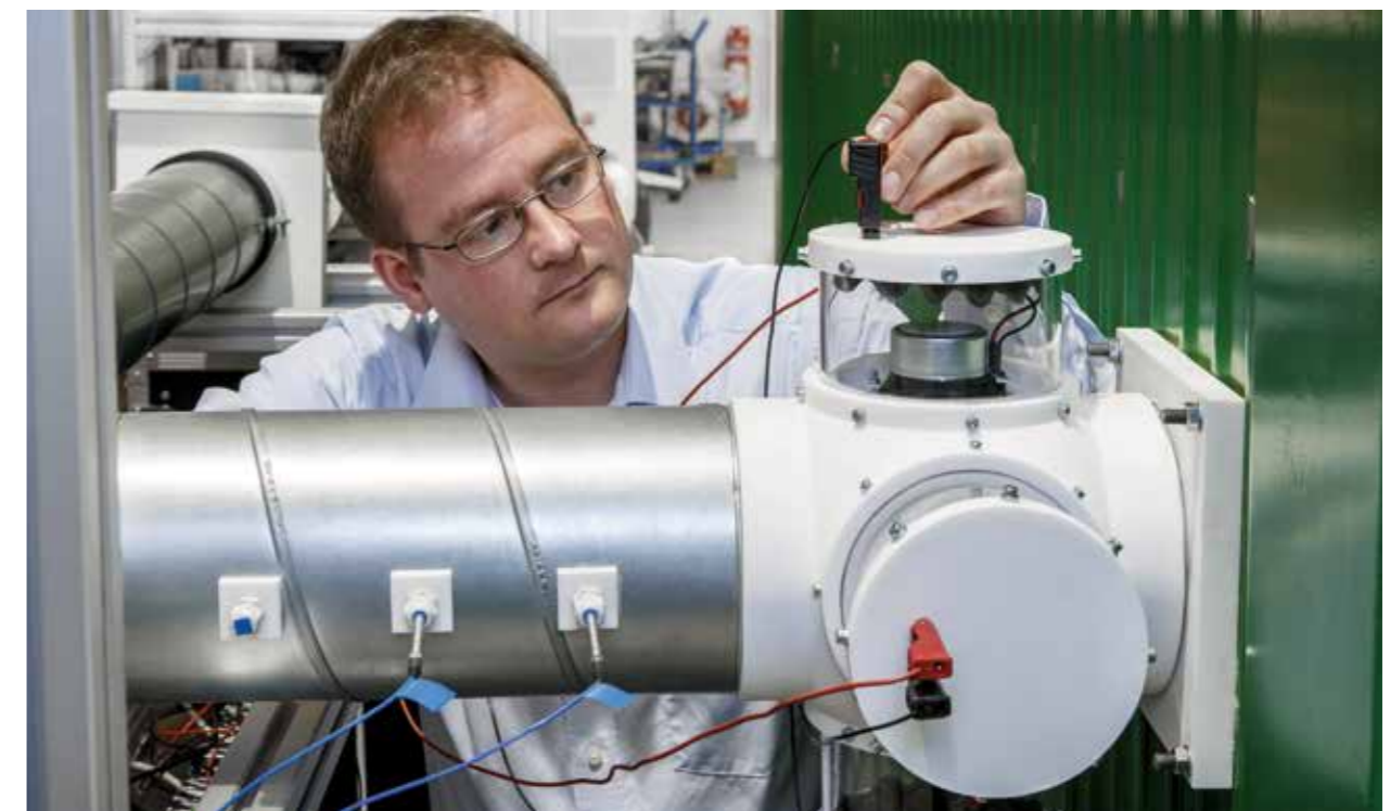
Bild 1: Low-Cost ANC-Modul zur Reduktion von Strömungsgeräuschen z. B. in Lüftungssystemen
